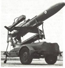
Die Aufklärungsdrohne Mirach 100 von Meteor wird als Bestandteil des Teilsystems SORAO innerhalb des Führungsinformationssystems CATRIN zum Einsatz kommen. Sie ist 850 km/h schnell und kann eine Nutzlast von 70 kg innerhalb eines Einsatzradius von 400 km mitführen.
