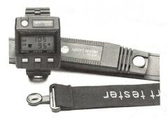
Entweder manuell, über Computer oder dem ebenfalls neu herauskommenden «Printerface» lassen sich die gespeicherten Herzfrequenzwerte ausdrukken und analysieren.
