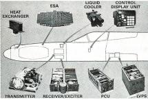
ASARS-2 sowie die Integration dieses mit einer zu beiden Seiten des Trägers TR-1 strahlenden V-förmigen Antenne ausgerüsteten Seitensichtradars im Rumpfbug der TR-1. (ADLG 6/88: Taktische Luftaufklärung)
