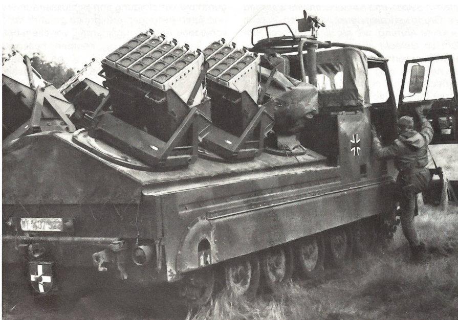
Das vorgeführte Minenwurfssystem (Mi WS) «Skorpion» auf dem Fahrgestell M 548 G-A1. In den Pionierkompanien der Brigaden sind 4 bzw 6 solcher Werfer. Die volle Kampfbeladung des Mi WS umfasst 600 Pzaw WMi, mit denen innerhalb von 10 bis 15 Min ein 1500 m breite Sperre gelegt werden kann.
