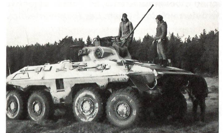
Der 20 Tonnen schwere Spähpanzer «Luchs». Das mit einer 20-mm-Maschinen-Kan und einem Flab Mg bewaffnete Pz Fz fährt auf der Strasse max 90 km/h und im Wasser 10 km/h. Der Redaktor durfte selber am Steuer sich von der einfachen Manövrierbarkeit und Geländegängigkeit überzeugen.
