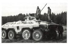
Der 20 Tonnen schwere Spähpanzer «Luchs». Das mit einer 20-mm-Maschinen-Kan und einem Flab Mg bewaffnete Pz Fz fährt auf der Strasse max 90 km/h und im Wasser 10 km/h. Der Redaktor durfte selber am Steuer sich von der einfachen Manövrierbarkeit und Geländegängigkeit überzeugen.
