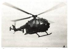
«Star» der Vorführungen war der Panzerwabwehrhelikopter BO 105 (PAH1). Er kann total 8 Hot Pzaw Raketen mitführen und bis max 3,8 km weit schiessen. Diese Pzaw Waffen werden im Schwarm von 7 Helikoptern eingesetzt.
