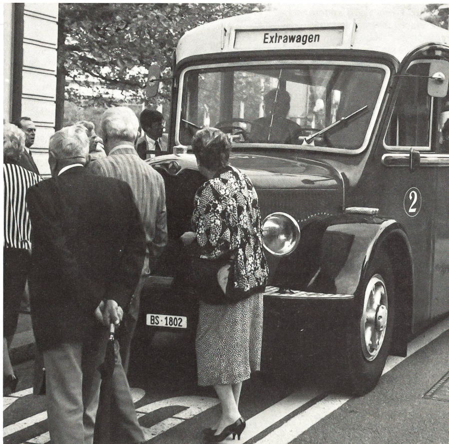
Wm Ernst Herzog organisierte die beeindruckende Rundfahrt durch die Rheinstadt Basel. Unser Bus der Verkehrsbetriebe Basel, mit Fahrer Kestenholz, Jahrgang 1930 und damals mit Benzinmotor, 1942 auf Holzgas umgebaut und 1947 mit einem Sechs-Zylinder-Dieselmotor ausgerüstet.
