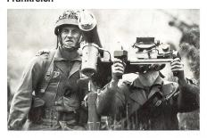
Fliegerabwehrrakete «Mistral» kurz vor dem Abschuss. Die Rakete wird mittels eines Infrarot-Zielsystems gelenkt und erreicht eine maximale Fluggeschwindigkeit von Mach 2,5. Mit dem Fliegerabwehrsystem (SATCP-Système sol-air très courte portée) können Helikopter bis zu einer Schussdistanz von 4 km und Flugzeuge bis max 6 km bekämpft werden. Das System wird auch auf die Eignung in der Schweizer Armee hin überprüft.
