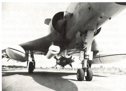
2000 mitgeführten Laser-Zielzuweisungsbehälter für den Tageinsatz mit einsitzigen Kampfflugzeugen entwickelt Thomson-CSF gegenwärtig ein auf einem FLIR-Sensor basierendes Nachtsichtpotential. Daneben kann beim Einsatz von BGL-Munition aber auch eine bodengestützte Laserzielmarkiereinheit Verwendung finden. (ADLG 11/86: BGL)
