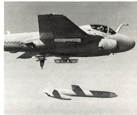
Fernlenkflugzeugs NV-144 von Northrop Ventura ab einem A-6-Intruder. Der Wettbewerbsbeitrag von Northrop erreicht eine Höchstgeschwindigkeit von rund 930 km/h und zeichnet sich bei einem Einsatz auf einer Höhe von 15 200 m und einer Nutzlastkapazität von 136 kg durch einen Aktionsradius von mehr als 800 km aus.
