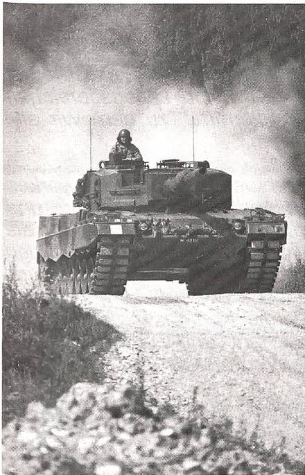
Geschoss, das dank seiner hohen Abschussenergie jede heute bekannte Panzerung durchschlägt. Daneben kann auch herkömmliche, vollkalibrige Mehrzweckmunition verschossen werden. Die Feuerleitanlage besteht aus primärstabilisierten Zielloptiken, einem Wärmebildgerät – im Hauptzielgerät integriert –, das bei Nacht und schlechten Sichtverhältnissen, auch bei getarnten Objekten, eine Zielerfassung erlaubt. Ein Laserentfernungsmesser sorgt für eine exakte Distanzmessung zum feindlichen Objekt.
