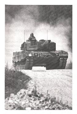
Der Leopard 2 ist in der Lage, bei kürzester Reaktionszeit – auch aus schneller Fahrt – fahrende Ziele mit hoher Erstschuss-Trefferwahrscheinlichkeit und mit vernichtender Wirkung zu bekämpfen. Seine überlegene Feuerkraft beruht auf der 120-mm-Glattrohrkanone, mit der zwei flügelstabilisierende Gefechtsmunitionsarten, mit verbrennbarem Hülsenschaft, verschossen werden können. Es handelt sich dabei um ein unterkalibriges
