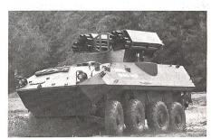
PIRANHA 8×8 der Firma MOWAG mit 81-mm-OERLI-KON-Mehrfach-Raketenwerfer.
