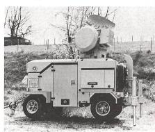
Der digitale Datenaustausch sowie die Sprechverbindung zwischen den beiden Geschützen und dem Feuerleitgerät Skyguard (Bild) erfolgt über zwei normale Feldtelefonleitungen.
