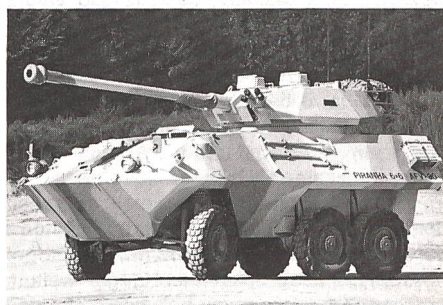
Der in der kanadischen Armee eingeführte PIRANHA 6x6 mit 76-mm-Kanone.
