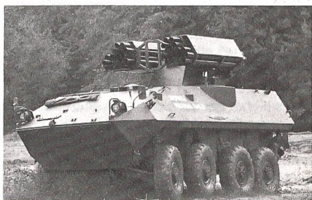
PIRANHA 8x8 der Firma MOWAG mit 81-mm-OERLIKON-Mehrfach-Raketenwerfer.
