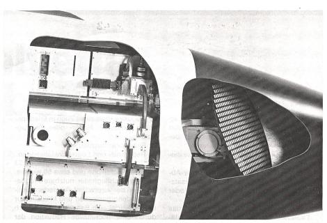
Das von LM Ericsson ausgelegte Leichtbau-Pulsdopplerradar PS-05A offeriert zahlreiche Betriebsarten in der Luft/Luft- und Luft/Boden-Einsatzrolle. Der Sensor soll im Laufe des Jahres 1987 an Bord eines Versuchsträgers Viggen seine Flugerprobung aufnehmen. Die Konstruktion des PS-05A zeichnet sich durch einen Radarschirm aus Glasfasermaterial, Selbstprüfeinrichtungen und wenigen, auf Staffelebene austauschbaren Baugruppen aus.
