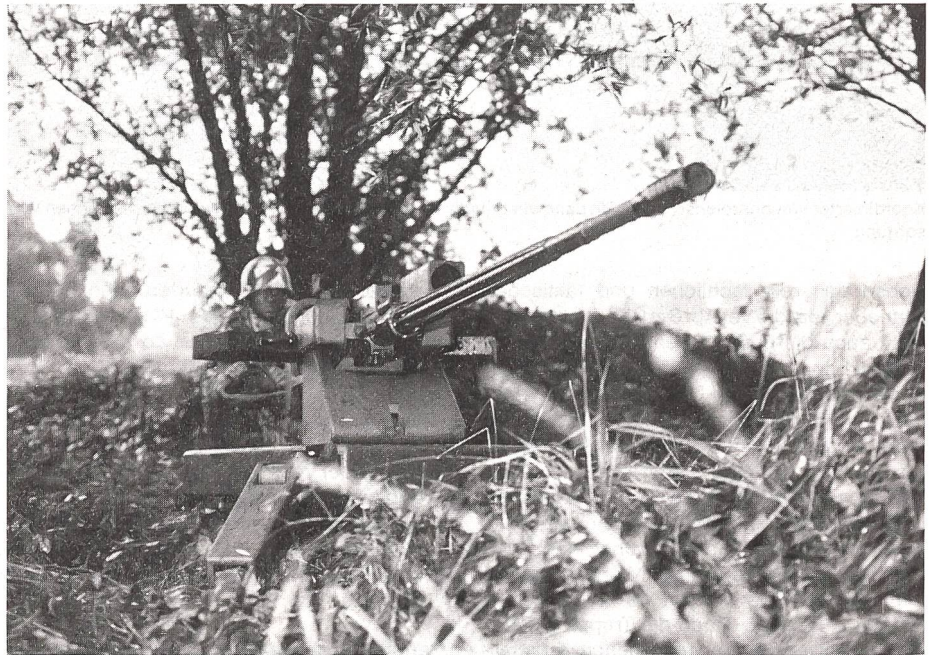
Die Abbildung zeigt eine von einer Schweizer Firma konzipierte moderne Mehrzweckkanone 25 mm im Einsatz ab Dreibeinlafette. Sie ist ein gezogenes, zerleg- und tragbares Infanteriegeschütz, das über moderne Technologien sowie eine hohe Funktionssicherheit verfügt und, stufengerecht eingesetzt, eine zuverlässige Infanterietauglichkeit aufweist.
