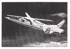
Unsere obige Aufnahme zeigt eine Modellfoto des Experimental-Fluggerätes S-72X1, das mit je zwei Strahlturbinen GE-T58-GE-10 für den Antrieb des Rotors bzw GE-TF34-GE-400A für den Vorwärtsschub ausgerüstet ist. Das folgende Illustratorbild veranschaulicht eine mögliche Serienversion für Geschwindigkeiten bis zu Mach 0,8. Als mögliche Einsatzrollen werden Luft- und Erdkampf-, Frühwarn-, elektronische Aufklärungs-, U-Bootbekämpfungssowie Such- und Rettungs-Missionen genannt. ka
