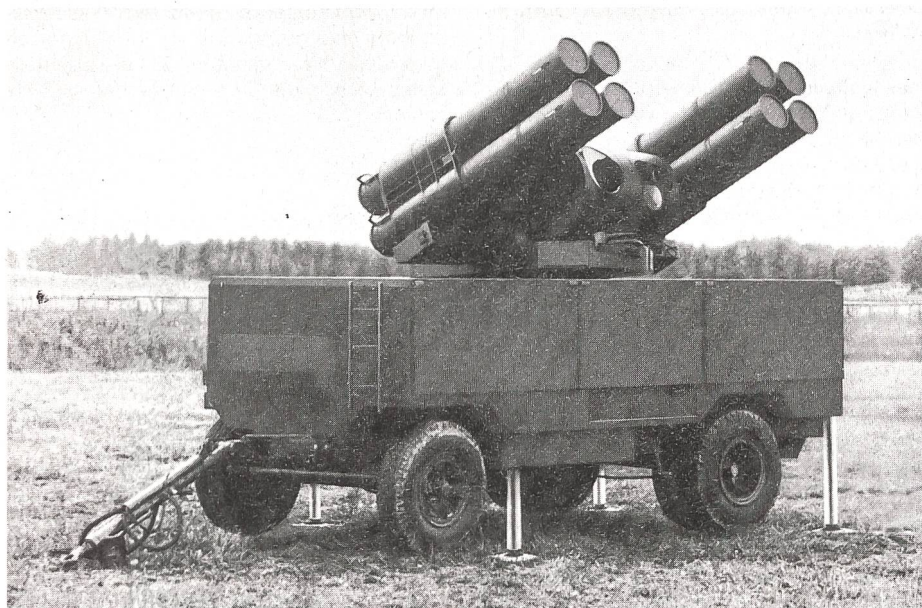
ADATS montiert auf einem Shelter. Diese Version eignet sich besonders gut für die Verteidigung ortsfester Anlagen, wie Flugplätze und Kommandoposten.
