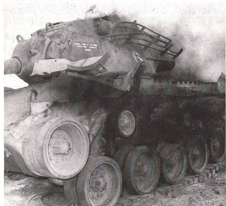
M-48-Panzer nach dem Beschuss durch einen ADATS-Flugkörper.
