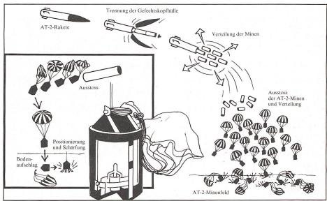
Abb 2: Funktionsschema für den Einsatz von Panzerabwehrwurfminen
