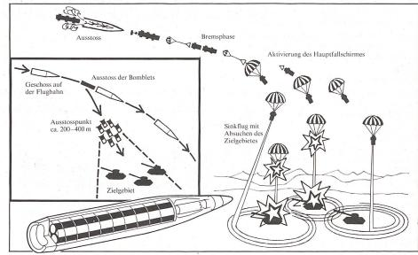
Abb 1: Funktionsschemas für den Einsatz von Bombletgeschossen
