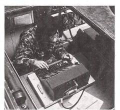
Abb 6: Bedienung des Feuerleitrechners des Systems FARGO im Feuerleitpanzer der Schweizerischen Panzerartillerie.
