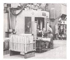
Mit einer Kraft von bis zu 3600 Tonnen werden Hülsen in mehreren Arbeitsgängen aus Rondellen geformt.
