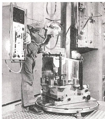
Bearbeiten des Bodenstücks für den Panzer 87 (Leo) mit modernsten Maschinen
