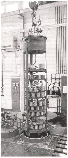
Diese rechnergesteuerte Gasnitrieranlage der Eidgenössischen Waffenfabrik Bern erlaubt das Härten fertig bearbeiteter Teile aus dem Waffenbau und der Maschinenindustrie. (W+F)
