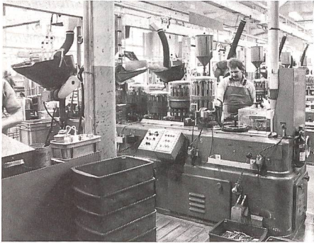
Gewehrpatronen (GP 11) Lademaschine (M+FT)
