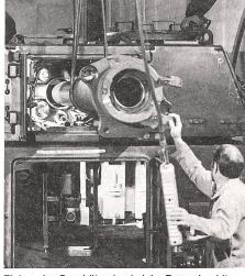
Einbau des Geschützrohrs bei der Panzerhaubitze (K+W)
