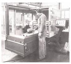
An moderne Munition und Munitionsbestandteile müssen sehr hohe Ansprüche gestellt werden. Die Qualitätsanforderungen in der mechanischen Fertigung erfordern den Einsatz leistungsfähiger Messund Prüfeinrichtungen. Unser Bild zeigt eine 3-Dimensionale Messmaschine.
