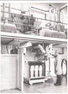
Unter strengsten Sicherheitsvorkehrungen werden die Geschosskörper mit Sprengstoff ausgegossen. (M+FA)
