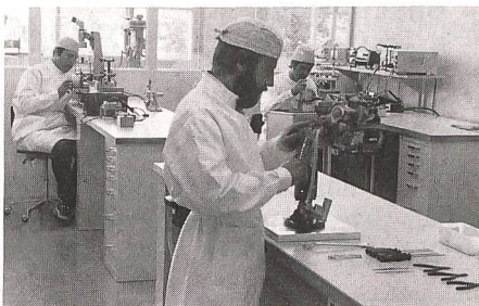
Elektronische wie hydraulische Baugruppen werden in diesem Spezialraum der Eidgenössischen Waffenfabrik Bern unter staubfreien Bedingungen zusammengebaut. (W+F)
