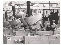
Der Fabrikationssaal mit den Hülsenziehmaschinen
