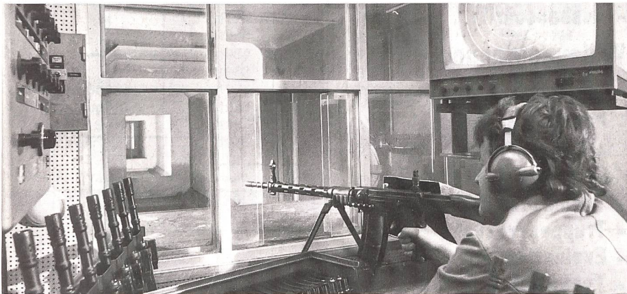
In der unterirdischen 300-m-Schiessanlage der Eidgenössischen Waffenfabrik Bern werden, ohne Beeinträchtigung der Umgebung, sämtliche Handfeuerwaffen vor der Ablieferung einem Abnahmebeschuss unterworfen. (W+F)
