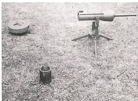
4 Panzerabwehrrminen (PAM) PzAbwMi 3 (links) - PzRiMi 1 (rechts) - PzAbwMi AT-2 (vorne)
