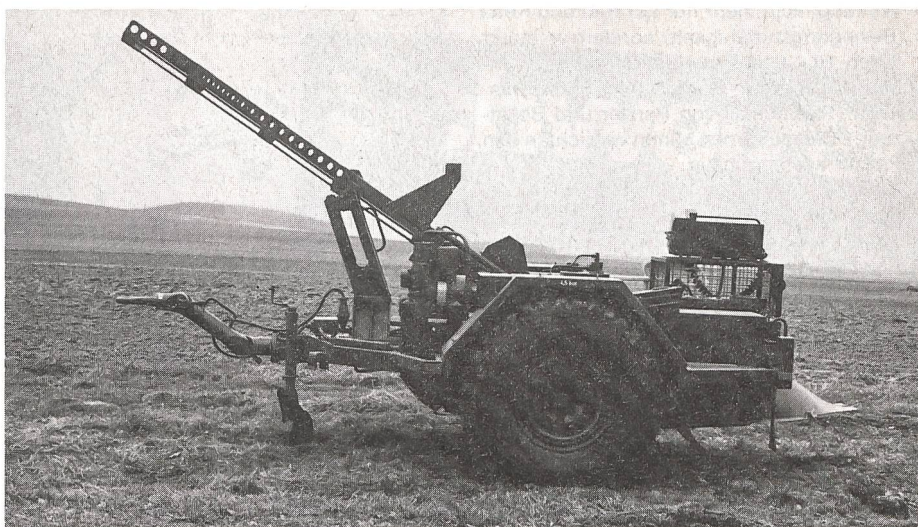
2 Minenverlegesystem (MiVS) 85 gezogen (System FFV 028)
