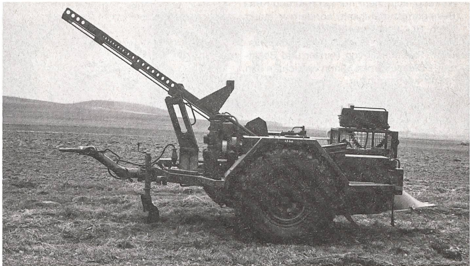
2 Minenverlegesystem (MiVS) 85 gezogen (System FFV 028)
