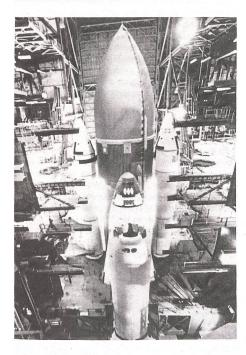
Die erste nach Wiederaufnahme des Space-Shuttle-Programms seit dem Unglück mit «Challenger» gebaute Raumfähre ist fertiggestellt worden. Unser Bild zeigt die mit den beiden Startraketen und dem grossen Treibstofftank zusammenmontierte Fähre «Atlantis» in der Montagehalle des Kennedy-Raumfahrtzentrums. Ab Mitte Oktober 1986 wurde sie auf ihre Startrampe gezogen und während 7 Wochen ge-
