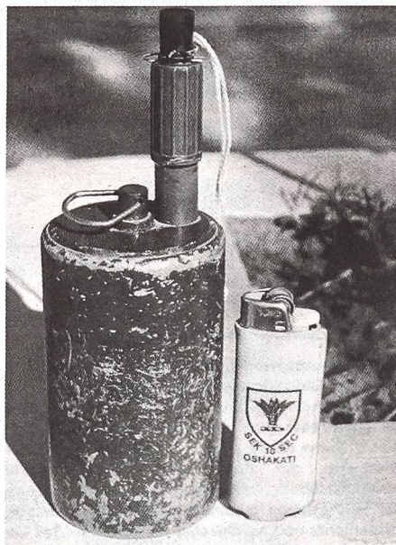
Eine in Angola entdeckte sowjetische Springmine OZM-4. Gut erkennbar sind das an der Mine angeschraubte Schlagstück und der daran befestigte Stolperdraht. Aus Internat Wehrrevue
