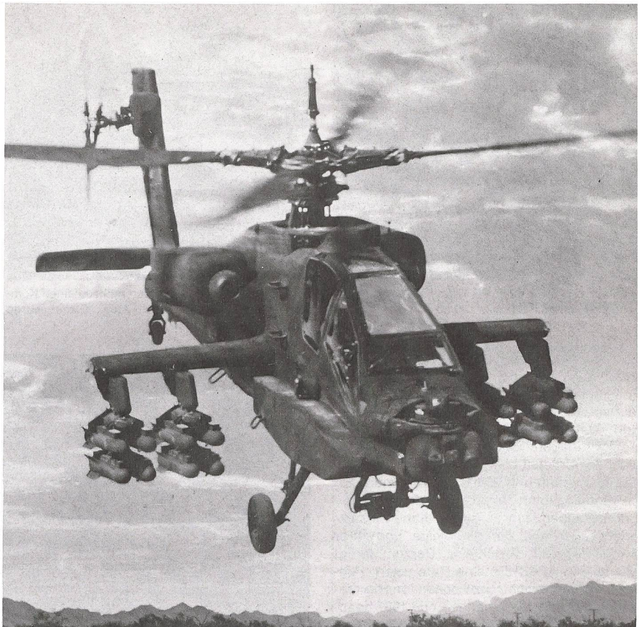
Erstmaliger Einsatz der US «Gunships» in Europa. MDHC AH-64 A «Apache» stärkster Allwetter- und Nacht-kampf-Kampfhubschrauber, hier auf dem Bild mit M 230 30 mm Chain Gun (MKan) und 16 Hellfire ATFK (Pzaw-Waf).
