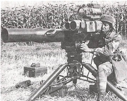
Infanterist der US Army richtet seine «TOW» ATFK (Pzaw) mit der neuen Nachtsicht-Wärmebild-Zielvorrichtung.
