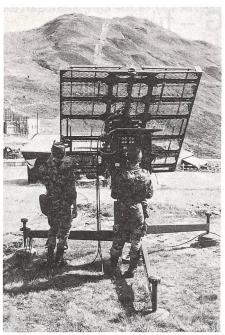
Die Ballonsonde wird mittels Peilgerät verfolgt.
