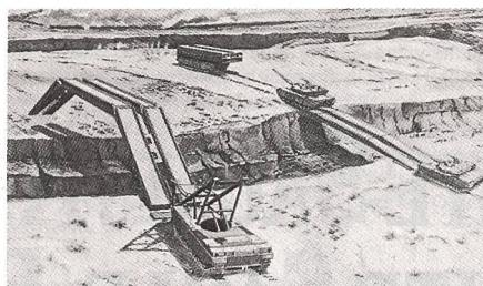
Um den logistischen Aufwand gering zu halten und der Truppe einen Brückenlegepanzer mit kompatibler Mobilität zu liefern, wurde die Brücke so konstruiert, dass sie sowohl auf dem M1- wie auf dem M60-Fahrgestell montiert werden kann.
