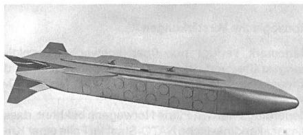
mehrere Einheiten mitführen kann. DWS39 wird alle von MBB entwickelten Submunitionstypen im autonomen Hochgeschwindigkeits-Tieffluge über einem vorgegebenen Zielgebiet ausstoßen können. Das Trägerflugzeug Gripen kann nach dem Ausklinken des DWS39 – ohne einen Zielüberflug gemacht zu haben – sofort abdrehen, was dessen Überlebensfähigkeit und Durchsetzungsvermögen auf einem Gefechtsfelde der 90er Jahre beachtlich steigern wird. (ADLG: 8/87: JAS39) ka
