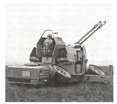
Das Bild zeigt das 35-mm-Zwillings-Flabgeschütz 63. Gut sichtbar ist die für die Kampfwertsteigerung vorgesehene integrierte kofferartige Steuerungs- und Energie-Versorgungs-Anlage (EVA). Damit entfallen die bisher für jedes Geschütz verwendeten Stromversorgungsanlagen in Form eines Einachsenanhängers sowie die hierfür notwendigen Kabelauslegungen. Das gewährleistet eine höhere taktische Mobilität (v a Stellungsbezug) und ist weniger personalintensiv
