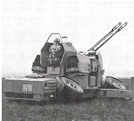
Das Bild zeigt das 35-mm-Zwillings-Flabgeschütz 63. Gut sichtbar ist die für die Kampfwertsteigerung vorgesehene integrierte kofferartige Steuerungs- und Energie-Versorgungs-Anlage (EVA). Damit entfallen die bisher für jedes Geschütz verwendeten Stromversorgungsanlagen in Form eines Einachsenanhängers sowie die hierfür notwendigen Kabelauslegungen. Das gewährleistet eine höhere taktische Mobilität (v a Stellungsbezug) und ist weniger personalintensiv.
