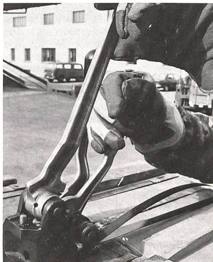
14 «Baverschlapp»-Bandverschlussapparat, den ein Munitionssoldat im Palettierdienst beherrschen lernt.
