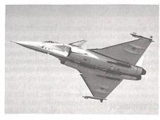
Das Bild zeigt «Rafale» mit 6 Luft-Luft-Raketen, 2 Raketen Magic II (an den Flügelenden) und 4 Mica unter und seitlich des Rumpfes. Die Abfangrakete Mica ist eine Waffe der dritten Generation. Sie ist nach dem Abschuss selbständig und mit einem aktiven Suchkopf ausgerüstet. Zur Zeit werden Flugversuche mit 2 Betriebsstoff-Zusatztanks von je 2000 Liter gemacht.
