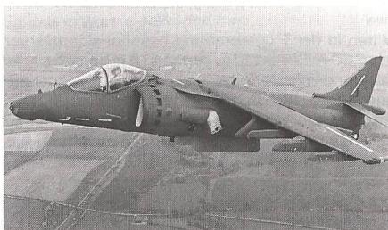
pelt so grosses Nutzlast-/Reichweiten-Potential. Von dem für das US Marine Corps in Auftrag gegebenen AV-8B unterscheidet sich die britische GR.5 u.a. durch einen Rollkartendisplay im Cockpit, das britische ECM-System Zeus von Marconi sowie zwei zusätzliche Nutzlaststationen für die Aufnahme von wärmeansteuernden Luftzielraketen AIM-9L Sidewinder/ AIM-132A ASRAAM als Bestandteil der Selbstschutzbewaffnung. Anlässlich der Luftfahrtsschau in Paris
