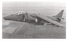
pelt so grosses Nutzlast-/Reichweiten-Potential. Von dem für das US Marine Corps in Auftrag gegebenen AV-8B unterscheidet sich die britische GR.5 u a durch einen Rollkartendisplay im Cockpit, das britische ECM-System Zeus von Marconi sowie zwei zusätzliche Nutzlaststationen für die Aufnahme von wärmensteuernden Luftzielraketen AIM-9L Sidewinder/AIM-132A ASRAAM als Bestandteil der Selbstschutzbewaffnung. Anlässlich der Luftfahrtschau in Paris
