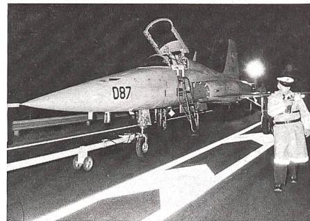
Ein Tiger F-5-Kampfflugzeug wurde auf der Strasse vom Militärflugplatz Interlaken bis ins AC-Zentrum bei Spiez geschleppt. Dort werden mit dem Flugzeug Versuche über die Auswirkungen sogenannter Elektromagnetischer Impulse (EMP), die bei einer Kernwaffenexplosion entstehen, untersucht. Keystone
