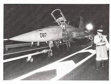
Ein Tiger F-5-Kampfflugzeug wurde auf der Strasse vom Militärflugplatz Interlaken bis ins AC-Zentrum bei Spiez geschleppt. Dort werden mit dem Flugzeug Versuche über die Auswirkungen sogenannter Elektromagnetischer Impulse (EMP), die bei einer Kernwaffenexplosion entstehen, untersucht. Keystone
