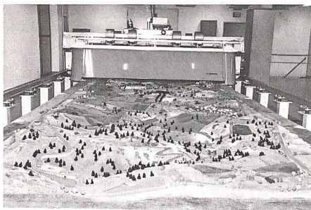
Überblick auf das Geländereief mit dem Vorschubsystem
