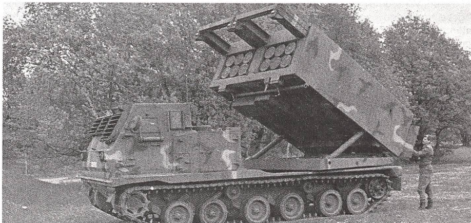
Das mittlere Artillerieraketensystem MARS der NATO unter der Bezeichnung MLRS (Multiple-Launch-Rocket-System) schiess bis 40 km weit. Das System verschiesst Raketen, die je mit sechs Submunitionen ausgerüstet sind. Diese Munition wird endphasen ins Ziel gelenkt. Es können ebenfalls Panzerminen damit verschossen werden.
