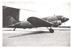
Vor vierzig Jahren gebaut und immer noch rüstig ist diese DC-3, die von der südafrikanischen Luftwaffe als Seeüberwachungsflugzeug eingesetzt wird. Im Bug befindet sich ein modernes Bendix-Radar, mit dem Schiffe auf grosse Distanz geortet werden können.
