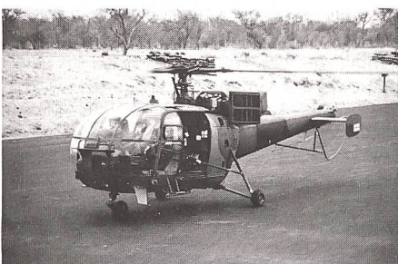
Alouette-III-Kampfhubschrauber auf dem Weg zu einem Einsatz im Grenzgebiet von Angola. Besonders gut sieht man hier die 20-mm-Kanone in der Kabine sowie den Sandfilter auf den Triebwerkseinläufen. Der Sand ist der grösste Feind für die empfindlichen Flugzeugtriebwerke und reduziert deren Standzeit erheblich.
