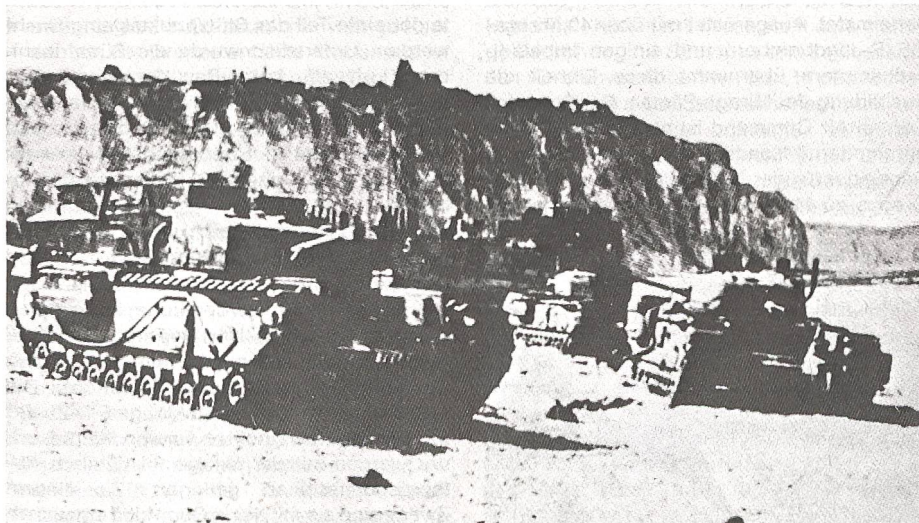
Von den alliierten Kommandotruppen verlassene Panzer vom damals neuen Typ «Churchill» an der Beach von Dieppe. Sie wurden weniger durch Direkttreffer der Pak, sondern infolge Fahrwerkschäden ausser Gefecht gesetzt (Foto: Associata Press).
