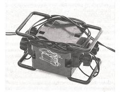
Der Pupinspulenkasten, mit dessen Hilfe sich die Kabeldämpfung auf völlig passive Weise reduzieren läest
