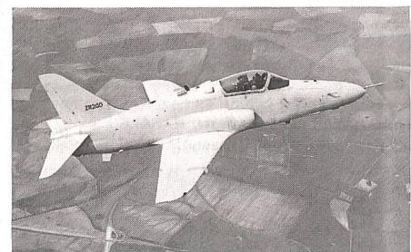
Strahltrainer Hawk. British Aerospace schlägt den von einer Strahliturbinen Rolls Royce Adour Mk 871 angetriebenen und mit einem leistungsfähigen Navigations-, Zielauffass- und Waffenzieldsystem ausgerüsteten Hawk 200 als kostengünstiges Luftangriffs-System für die Bekämpfung von Erd- und Seezielen vor. Die interne Bewaffnung des neuen Flugzeugs umfasst zwei Maschinenkanonen Aden des Kalibers 25 mm. (ADLG 11/86)
