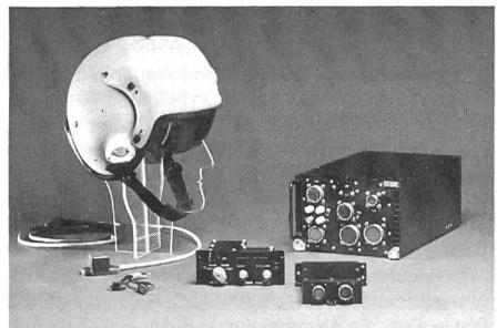
Helmsicht- und -visiersystem. Mit dieser DASH (Display And Sight Helmet) genannten, aus einem 150 g schweren Visieraufsatzt, einem 20 g schweren Empfängerteil im Pilotenhelm, einem im Kabinendach angebrachten Minisender sowie einem 11 kg schweren Rechner im Flugzeugrumpf bestehenden Anlage können im Luft- und Erdkampf folgende wichtigsten Aufgaben ausgeführt werden:
