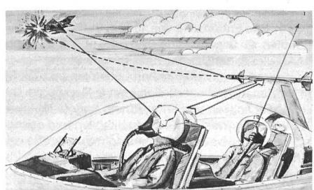
DASH versorgt den Piloten auch mit den wichtigsten Flug-, Navigations-, EloKa- und taktischen Daten, was die Notwendigkeit des Blicks auf Head-Up und Head-Down-Displays in den kritischen Phasen eines Einsatzes nicht mehr nötig macht. ka
