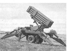
schiesst bis 30 km weit. Die Container mit 18 Artillerieraketen sind vergleichbar mit einem Gewehrmagazin. 2 davon können je mit 18 Raketen auf dem Zugfahrzeug von 5 Tonnen mitgeführt werden. 1 Magazin ist abschussbereit auf dem Anhänger als Abschussplattform. Das Nachladen des ausgeschossenen Werfers erfolgt in nur 4 Minuten.
