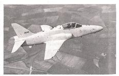
Strahltrainer Hawk. British Aerospace schlägt den von einer Strahlturbine Rolls Royce Adour Mk 871 angetriebenen und mit einem leistungsfähigen Navigations-, Zielauffass- und Waffenzielsystem ausgerüsteten Hawk 200 als kostenwirksames Luftangriffsystem für die Bekämpfung von Erd- und Seezielen vor. Die interne Bewaffnung des neuen Flugzeugs umfasst zwei Maschinenkanonen Aden des Kalibers 25 mm. (ADLG 11/86)
