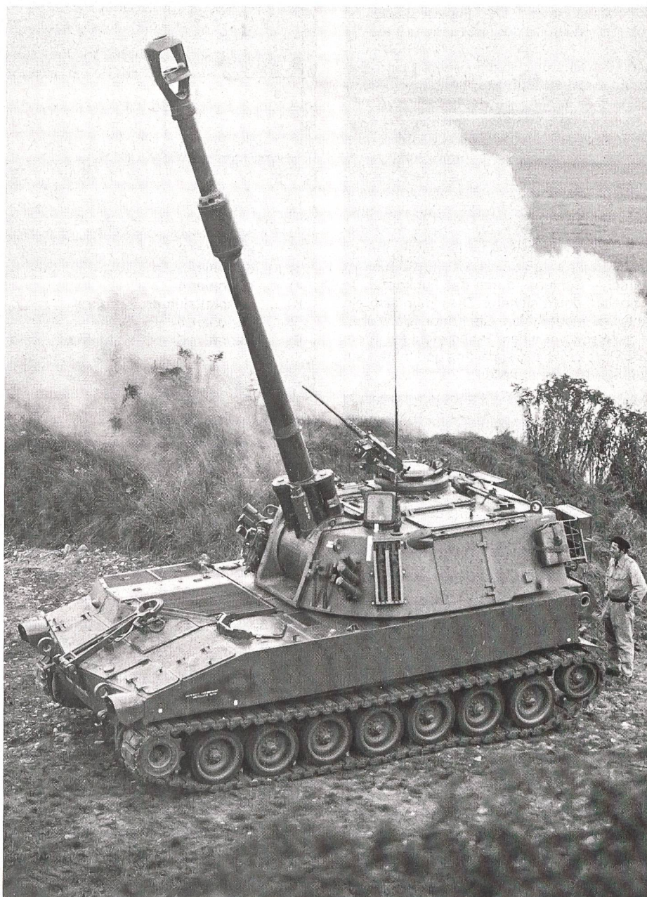
Pz Hb in Feuerstellung / Im Gegensatz zu den Kampfpanzern muss die Pz Hb zum Schiessen anhalten.
