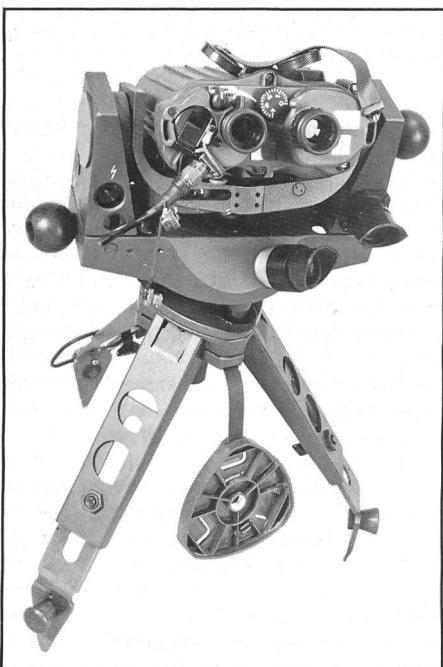
Mit dem Laser-Goniometer 85 können sowohl Distanzen als auch Azimut- und Elevationswinkel exakt und rasch gemessen werden. Die Beschaffung derartiger Geräte wurde bereits mit dem Rüstungsprogramm 1985 für die Ausrüstung der Artillerie-Schiesskommandanten bewilligt. Die Beschaffung erfolgt hauptsächlich bei der Firma Wild Heerbrugg AG.
