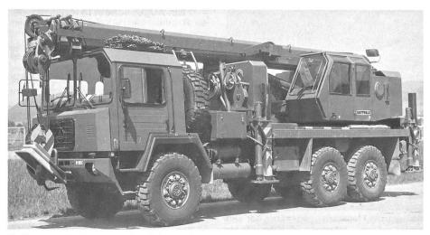
Als Ersatz von Kranwagen aus den fünfziger Jahren sollen 100 Kranaufbauten 20t beschafft werden. Diese werden auf Saurer-Lastwagenchassis 10t 6×6 aufgebaut. Von den mit dem Rüstungsprogramm 1982 beschafften 1200 Lastwagen wurden seinerzeit 100 für diesen Zweck reserviert. Als Kranaufbau wurde das System der Firma Gottwald, Düsseldorf (BRD), gewählt. An der Herstellung werden als Unterlieferant die Ateliers de Constructions Mécaniques de Vevey SA beteiligt sein.
