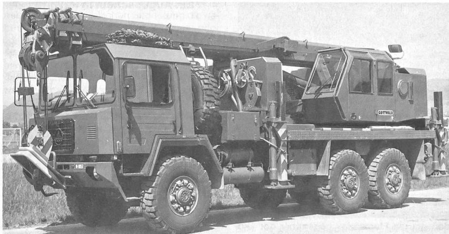
Als Ersatz von Kranwagen aus den fünfziger Jahren sollen 100 Kranaufbauten 20t beschafft werden. Diese werden auf Saurer-Lastwagenchassis 10t 6x6 aufgebaut. Von den mit dem Rüstungsprogramm 1982 beschafften 1200 Lastwagen wurden seinerzeit 100 für diesen Zweck reserviert. Als Kranaufbau wurde das System der Firma Gottwald, Düsseldorf (BRD), gewählt. An der Herstellung werden als Unterlieferant die Ateliers de Constructions Mécaniques de Vevey SA beteiligt sein.
