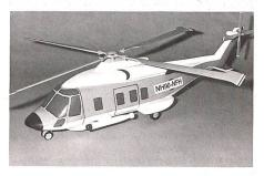
Überlebensfähigkeit. Weitere charakteristische Merkmale sind ein BERP (British Experimental Rotor Programme)-Hauptrotor, ein Vierblatt-Anti-Torque-Heckrotor, eine Zelle aus Faserverbundwerkstoff sowie eine Fly-By-Wire-Steuerung. Ferner sind ein Dreipunkt-Landewerk mit hoher Energieaufnahmekapazität, Vorkehrungen für geringe Verwundbarkeit und Erfassung durch den Gegner sowie ein flexibles System-Layout für verschiedene Missionsausrüstungen vorgesehen.
