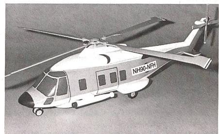
Überlebensfähigkeit. Weitere charakteristische Merkmale sind ein BERP (British Experimental Rotor Programme)-Hauptrotor, ein Vierblatt-Anti-Torque-Heckrotor, eine Zelle aus Faserverbundwerkstoff sowie eine Fly-By-Wire-Steuerung. Ferner sind ein Dreipunkt-Landewerk mit hoher Energieaufnahmekapazität, Vorkehrungen für geringe Verwundbarkeit und Erfassung durch den Gegner sowie ein flexibles System-Layout für verschiedene Missionsausführungen vorgesehen.
