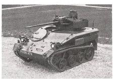
Wiesel MK/A1 mit Maschinenkanone 20 mm (MK 20 mm)
