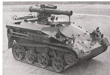
Wiesel TOW/A1 mit Panzerabwehr-Lenkwaffensystem TOW/Pars TOW
