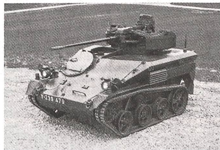
Wiesel MK/A1 mit Maschinenkanone 20 mm (MK 20 mm)
