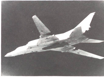
Der sowjetische Überschall-Schwenkflügel-Bomber «Backfire» (NATO-Bezeichnung) gilt als Mittelstreckenbomber, kann aber bei Luftbetankung auch interkontinentale Einsätze fliegen.
