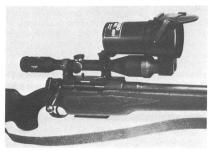
Die SIMRAD-KN-250-Nachtsicht, montiert auf einer Smith & Bender-Sicht (in Norwegen produziertes Präzisionsgewehr VS 84 S von Våpensmia).
