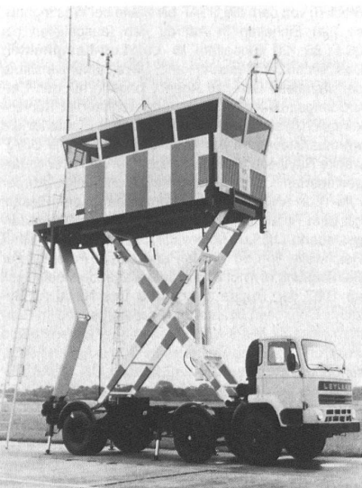
Flugverkehrskontrollturm im Container, der mit einer Scherenhubbühne auf die erforderliche Betriebshöhe gebracht wird.
