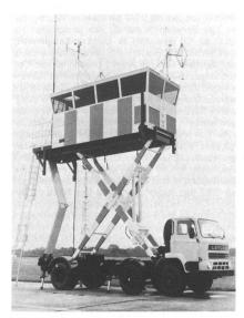
Flugverkehrskontrollturm im Container, der mit einer Scherenhubbühne auf die erforderliche Betriebshöhe gebracht wird.
