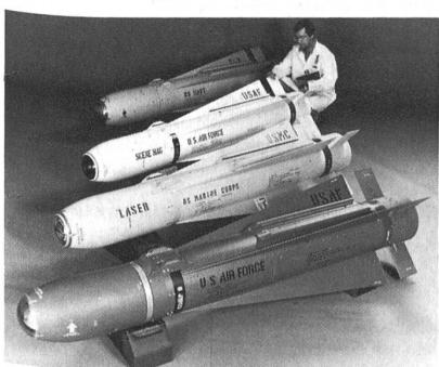
● Infrarot-Wärmebildgesteuerte Version AGM-65D
