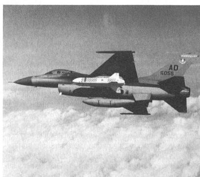
Altitude Dispenser). Die LDLAD genannte luftwiderstandsarme Konfiguration wird zurzeit an Bord eines Jagdbombers F-16 flugerprobt (Bild). Brunswick Defense schlägt das LAD-System für den Abstandseinsatz aus einem erdnahen Angriffsprofil als Basis für folgende Luft/Boden-Munitionsentwicklungen der USAF bzw der NATO vor:
