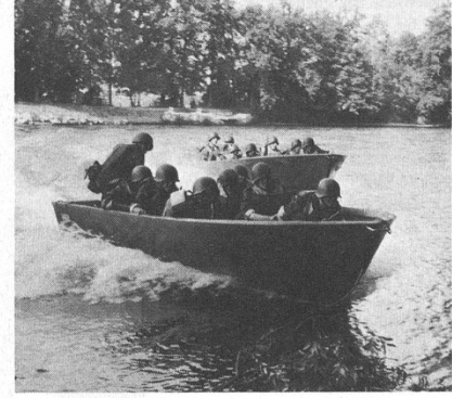
Volle Konzentration für den Steuermann! Mit Vollgas (kriegsmässiger Einsatz) auf das Ufer und kurz vor Grundberührung Gas weg – Motor mit Propeller hochziehen –, dies erfordert Konzentration und viel Gefühl.
