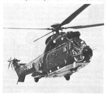
nach dem Ausfall verschiedener Alouette verlorengegangene Transportkapazität wettzumachen. Der Super-Puma (Bild) kann 18 vollausgerüstete Soldaten transportieren. Keystone
