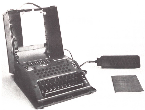
Die NEMA, ein nach dem 2. Weltkrieg entwickeltes Nachfolgemodell der ENIGMA, bei welchem durch eine Vergrösserung der Walzenzahl und durch einen komplizierteren Vorschubmechanismus eine wesentliche Verbesserung erzielt wurde. Sie gilt auch heute noch als nur schwer in nützlicher Zeit «brechbare» Verschlüsselungsmaschine.
