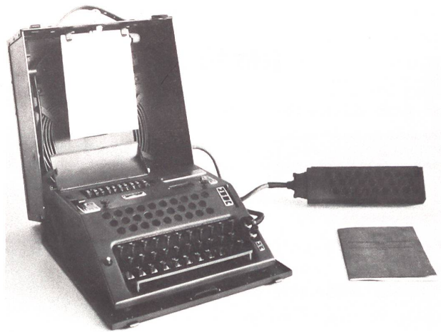
Die NEMA, ein nach dem 2. Weltkrieg entwickeltes Nachfolgemodell der ENIGMA, bei welchem durch eine Vergrößerung der Walzenzahl und durch einen komplizierteren Vorschubmechanismus eine wesentliche Verbesserung erzielt wurde. Sie gilt auch heute noch als nur schwer in nützlicher Zeit «brechbare» Verschlüsselungsmaschine.
