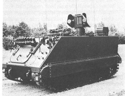
Unsere Fotos zeigen unten die tragbare und oben die auf einem Mannschaftstransportwagen M-113 integrierte Version der PARS 3 MR. Der tag/nacht- und schlechtwetterkampffähige Lenkflugkörper ist mit einem den Überflug-Dachangriff oder die Direktbekämpfung ermöglichen Hohlladungsgeschoss ausgestattet. Ausgerüstet mit einer La-
