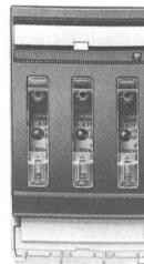
Der Sicherungs-Lasttrenner für eine einfache Montage hinter beweglichen Abdeckungen oder in feste Fronten. Mit 3poligen Unterteilen aus glasfaserverstärktem Polyester-Duroplast. Mit seitlichen Abstandsnocken, die unmittelbar nebeneinanderliegende Anreihung verschiedener Trenner ermöglichen. Grösse 00 verfügt über einen zweiteiligen, Grösse 1 bis 3 über einen einteiligen Berührungsschutz.
