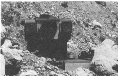
Panzerjäger in Feuerstellung. Silhouette etwas mehr als 1 m 2 Rechts ist das Kdt-Fernrohr für die Zielzuweisung sichtbar.
