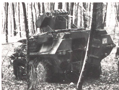
Gut sichtbar am Turm die 2×4-Nebelwerferrampen sowie hinten links das Hilfsaggregat für den stationären Betrieb.
