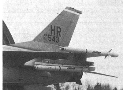
ermöglicht die als wartungsfreie Munition nach dem «Wooden Round»-Prinzip ausgelegte ASRAAM die Mehrfachzielbekämpfung ohne Folgehandlung des Piloten. Die Suchkopfelektronik des mit einem abbildenden Infrarotzielsuchkopfes sowie einem aktiven Infrarotannäherungszünders ausgerüsteten Lenkflugkörpers wird im Normalfall von der Bordradarantenne nachgeführt, was eine verzugsarme Bekämpfung von aufgefassten und als feindlich identifizierten Zielen ermöglicht. Weitere Betriebsarten sind das
