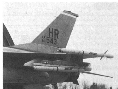
ermöglicht die als wartungsfreie Munition nach dem «Wooden Round»-Prinzip ausgelegte ASRAAM die Mehrfachzielbekämpfung ohne Folgehandlung des Piloten. Die Suchkopfelektronik des mit einem abbildenden Infrarotzielsuchkopfes sowie einem aktiven Infrarotannäherungszünders ausgerüsteten Lenkflugkörpers wird im Normalfall von der Bordradarantenne nachgeführt, was eine verzugsarme Bekämpfung von aufgefassenen und als feindlich identifizierten Zielen ermöglicht. Weitere Betriebsarten sind das
